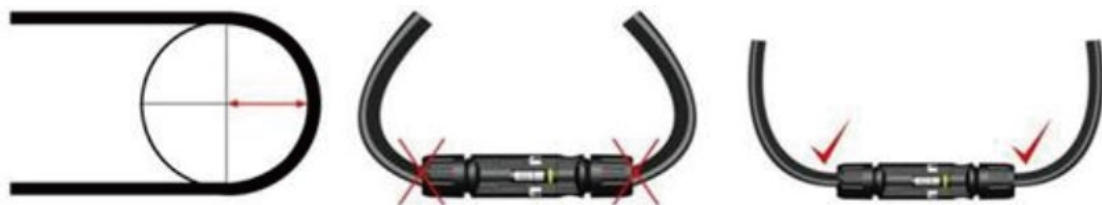
Abbildung: MINDESTBIEGERADIUS DES KABELS
